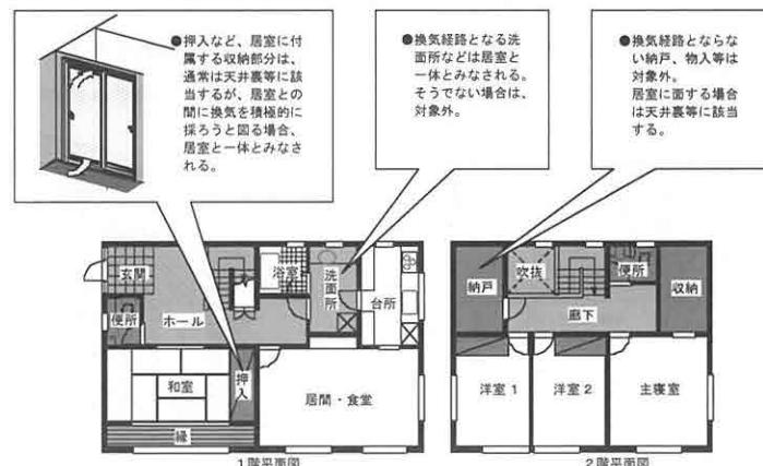
**換気設備が必要となる天井裏等** 天井裏等に第1種ホルムアルデヒド発散建築材料又は第2種ホルムアルデヒド発散建築材料を用いた場合、天井裏等において発散したホルムアルデヒドが居室内に漏れ出さないように、天井裏の換気が必要である。この場合の天井裏等とは、居室等に面する天井裏、小屋裏、床裏、壁、物置その他これらに類する部分で、押入などの収納スペース（居室等と通気が當時あるものを除く）も含まれる。ただし、間仕切り壁以外で天井裏と居室等との間に気密層を設けた場合、又は間仕切り壁と居室、天井及び床との間に合板等による通気止めを設けた場合は、天井裏等への換気設備の設置を免除できる。
