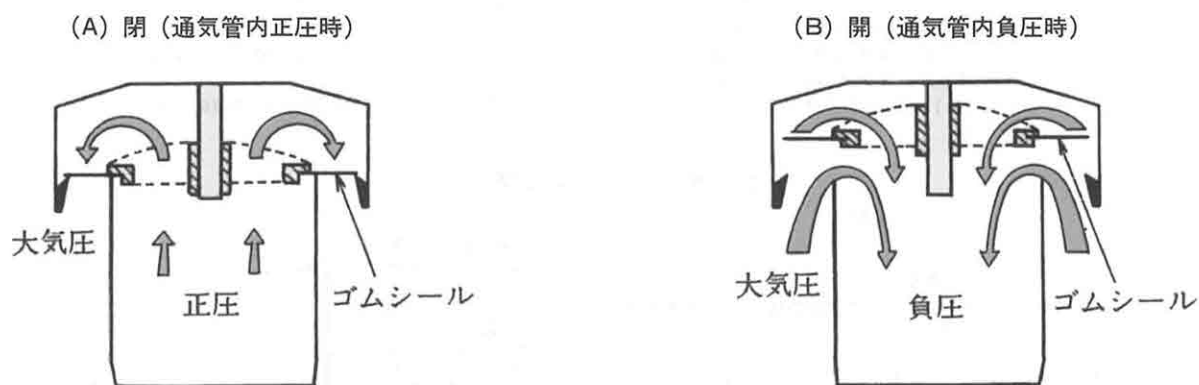
参考図13.3-1 通気弁の作動
