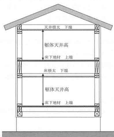
(A) 構造躯体高さが同一の場合
