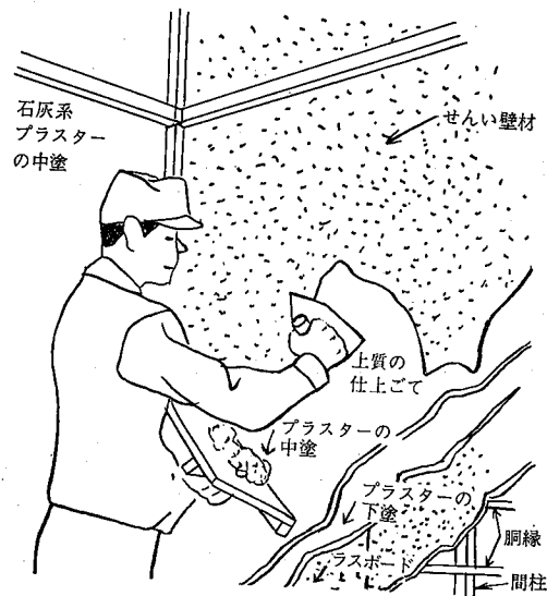
参考図 6.5.3-3 せいの壁こて塗り
