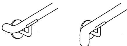
参考図 I.4.4-2 手すり端部の曲げ処理
