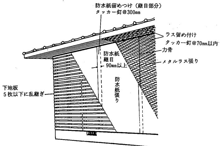
ワイヤラス 普通鉄線、なまし鉄線、亜鉛めっき鉄線をひし形、甲形又は丸形に編んだ網で、鉄線の直径は 0.9mm から 1.2mm、網目の寸法は 20mm から 38mm まである。強度と耐久性などから鉄線の径が大きく網目の寸法の小さいものが良い。
