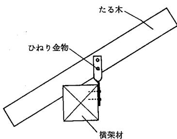
けた行筋かい、振れ止めの断面寸法は
