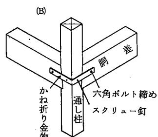
参考図 5.1.3. 柱と横架材の仕口の分類
