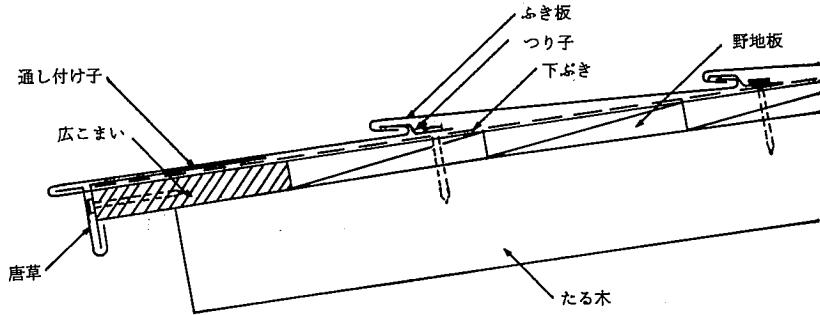
**段ぶき** 段ぶきは、通称横ぶきともいわれており、古くからある一文字ぶきの応用として軽微な屋根に用いられてきた。一文字ぶきのやや平板的な仕上がりに対し、流れ方向の接合部を段状にして材質に厚みをもたせた意匠に仕上がる。
