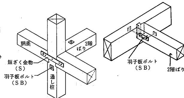
**接合金物** 床ばりの継手に用いられるボルトなどの接合金物は、地震や風圧によって生ずるはりの軸方向引張力に抵抗させるため、材相互の連結を確実にするのが主な目的である。
