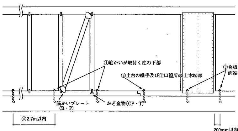
参考図 3.3.6 アンカーボルトの据付方法
