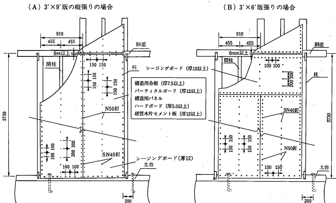
(注1) アンカーポルトの位置は柱心より200mm以内とし、なるべく耐力壁の外側に設けた方が良い。
