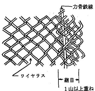
特殊ラスには金属加工片面ラス、金属板穴あきラス、金属加工両面ラス、金属網に防水紙・クラフト紙などを裏打ちしたものなどが市販されている。
