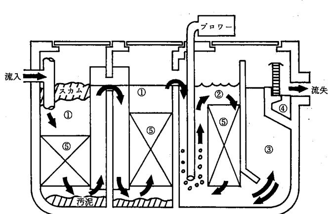
① 嫌気濾床槽：汚水を固体と液体に分離し、汚水中の汚濁物質を嫌気性微生物により分解する。
