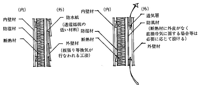
参考図 7.6.4図 壁の断熱材施工例
