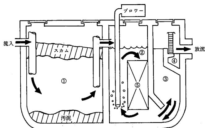
① 沈澱分離槽：汚水を固体と液体に分離し、液体部分をばっ氣槽に送る。
