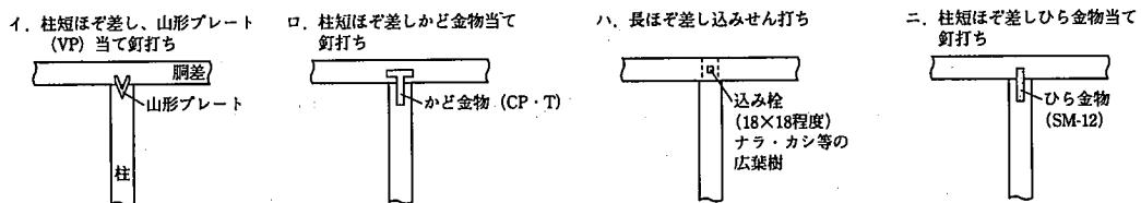
参考図 5.1.3.-3 隅柱と土台との仕口例 (筋かいの取りつく隅柱は除く)
