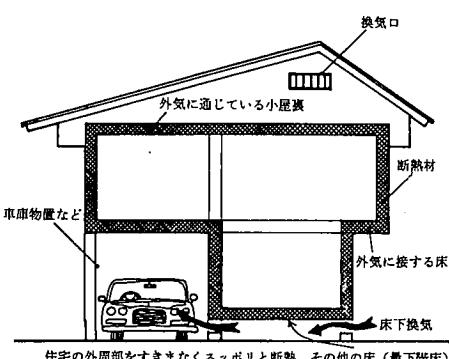
床下換気口が設けられた1階の床（その他の床）は、直接外気に接してはいないが床下を介して外気に接している。この場合の断熱材の厚みは、外気に接する床に比べ少し薄くてよいこととなっており、7.4(断熱性能)では「その他の床」として、はねだし床の場合のような「外気に接する床」と区別して数値が示されている。
