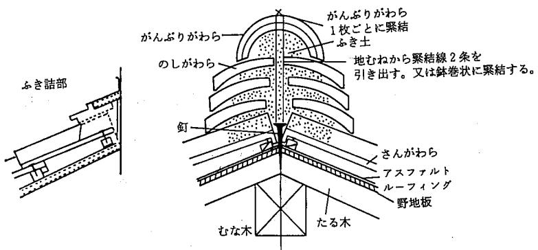
**留めつけ** 建築基準法施行令第39条に定める基準(建設省告示第109号昭46.1.29)で「屋根がわらは、軒及びけらばから2枚通りまでを1枚ごとに、その他の部分のうちむねにあっては1枚おきごとに銅線、鉄線、くぎ等で下地に緊結し又はこれと同等以上の効力を有する方法ではがれ落ちないようにあくこと。」と規定されているが、本仕様で
