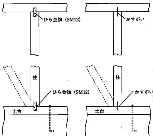
参考図 5.2.2-3 筋かいが取り付く隅柱と土台の仕口の例
