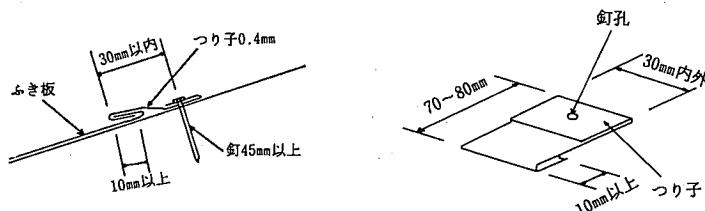
つり子(吊子) 金属板で屋根をふくとき、板を留めるために用いる小さな短ざく形の金物。
