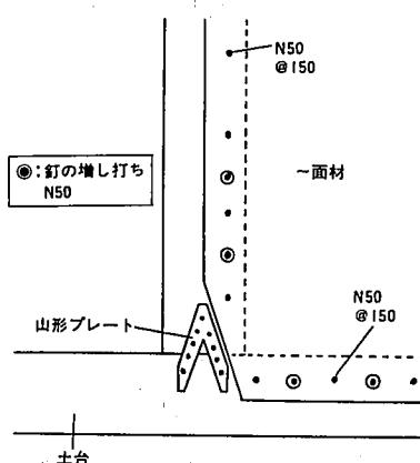
参考図5.4 真壁造における構造用面材の張り方
