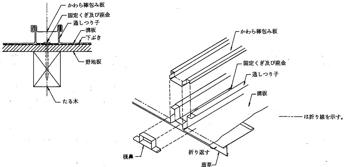
**一文字ぶき** 平板ぶきの代表的な屋根ぶき工法の名称で、別名「あやめぶき」ともいう。鋼板や銅板を長方形に板取りして、横の継手が一の字につながるよう軒先からむねに向って左右のいずれかの一方からぶく工法である。
