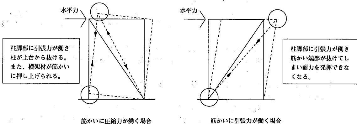
参考図 5.2.1 筋かい上下端の仕口
