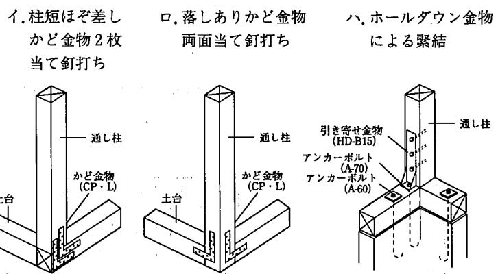
参考図 5.2 筋かいを用いた耐力壁の各端部における接合方法の例
