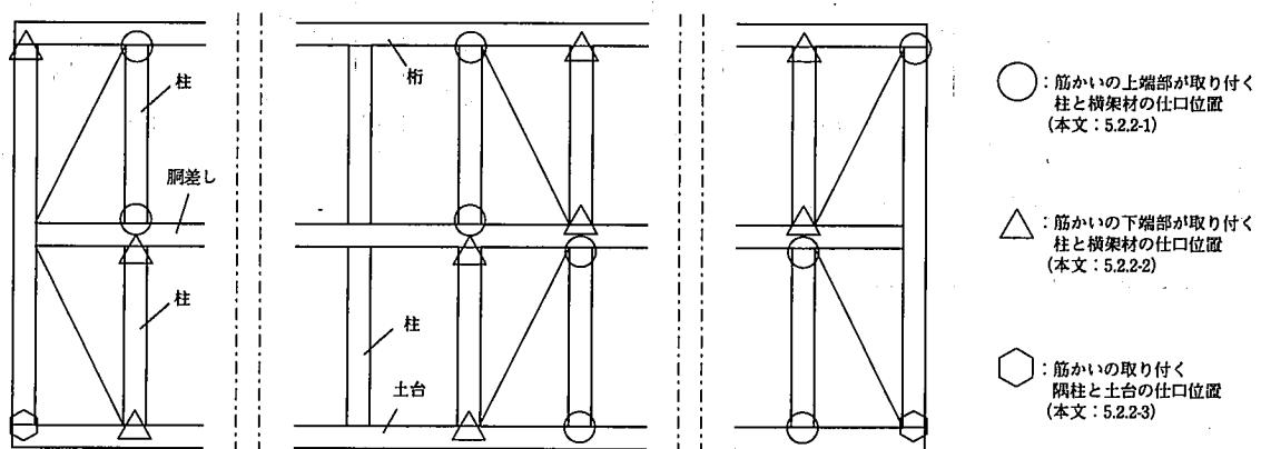
(注) この図は、本文に示している柱と横架材との仕口の位置を部分的にモデルとして表したものであり、
