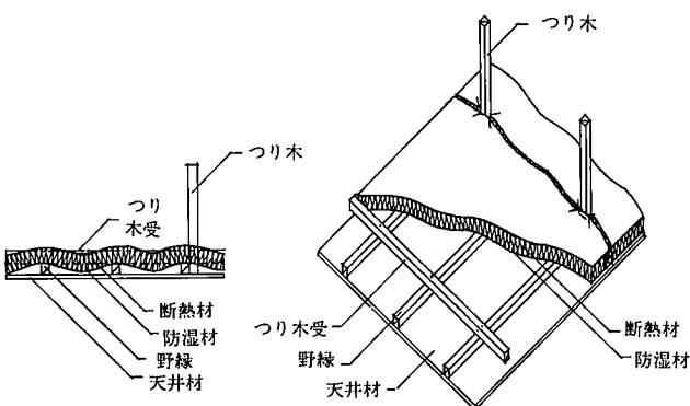
**ダウンライト** 断熱材を敷き込んだ天井等にダウンライト等を設ける場合、(社)日本照明器具工業会では、埋込み形照明器具の規格（J I L5002）を定めており、断熱材との関係から次のような器具が提案されている。
