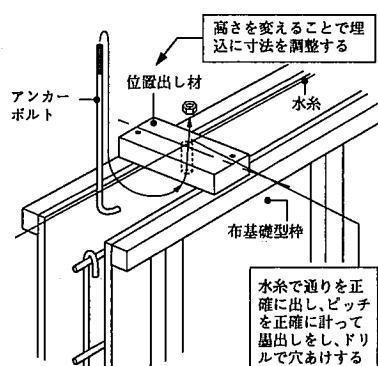
アンカーボルトは所定の位置に垂直に付設されるように位置出し材を布基礎型枠材に釘打ちしてアンカーボルトを据え付けてからコンクリートを打設するのが望ましい。
