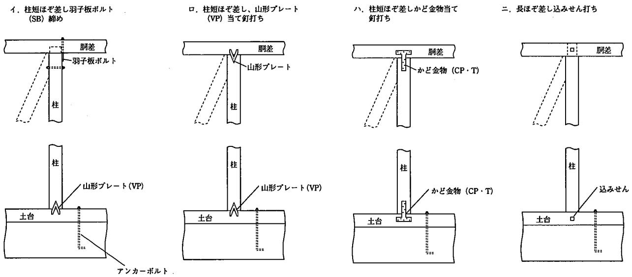
参考図 5.2.2-2 筋かいの下端部が取り付く
