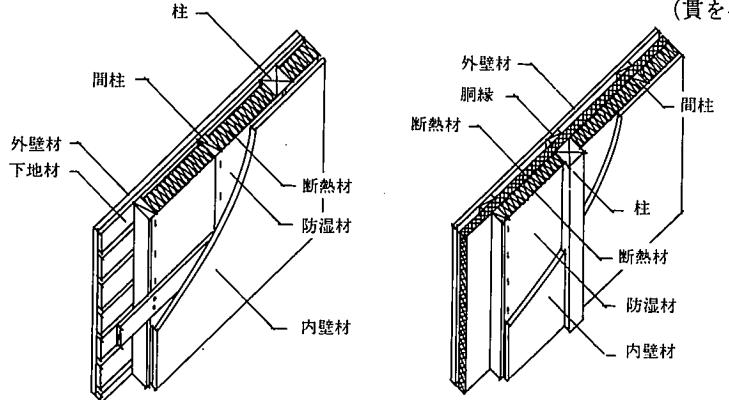
発泡プラスチック系断熱材の外張り（大壁） 無機繊維系断熱材の充てん（大壁）
