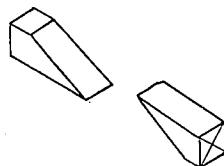
(2) 仕口 二つ以上の部材が直角、あるいはある角度をなして結合される場合、その結合部分を仕口という。仕口の一種にはぞ差し工法がある。これは柱又は横架材にはぞ穴をつけ、これにぞ加工した材をさし込み、くさび締、釘、込み栓などによって結合する方法である。ぞには、平ぞ、長ぞ、短ぞ、小根ぞ、扇ぞなどがある。
