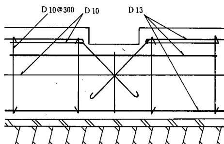
(注) 換気口廻りはD13 (13φ) の横筋及びD10 (9φ) の斜め筋により補強する。
