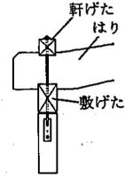
けた行筋かい 小屋組がけた行方向に倒れるのを防ぐため、小屋づかをつなぐけた行方向の筋かいをいう。
