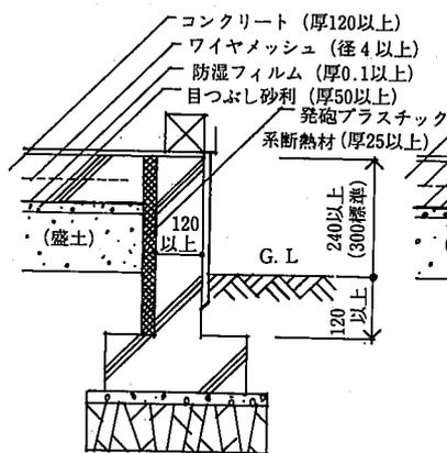
(ロ) 外壁断熱施工例
