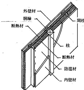
発泡プラスチック系断熱材の外張り (大壁)
