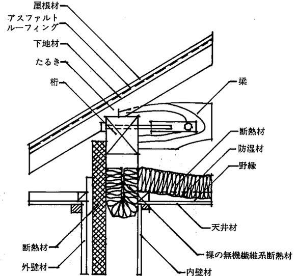
間仕切り壁部の通気止め施工例
