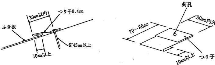
かわら棒ぶき かわら棒ぶきには、心木ありかわら棒ぶき、心木なしかわら棒ぶきがあり、長尺(コイル)の材料を使ってふくため、板の継ぎ目がないので、雨漏りの恐れが少なく、緩勾配の屋根でもふくことができる。なお、金属板ぶき工法のうち鋼板によるものについては、亜鉛鉄板会「鋼板製屋根構法標準」を参考にするとよい。
