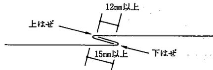
(注) 雨水の毛細管現象を防ぐために、はぜの折り返し寸法に十分注意する必要がある。
