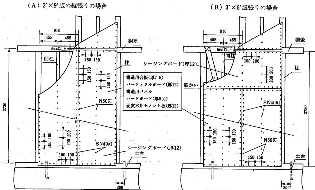
(注) アンカーボルトの位置は柱心より200mm以内とし、なるべく耐力壁の外側に設けた方がよい。
