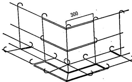
(注) 隅角部では各横筋を折り曲げた上直交する他方向の横筋に300mm以上重ね合せる
