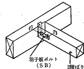
**接合金物** 床ばりの継手に用いられるボルトなどの接合金物は、地震や風圧によって生ずるはりの軸方向引張力に抵抗させるため、材相互の連結を確実にするのが主な目的である。
