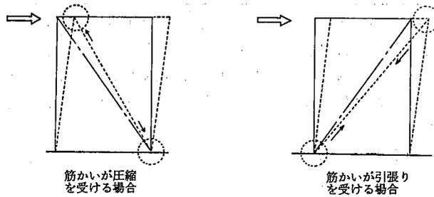
参考図 5.2.1 筋かい上下端の仕口
