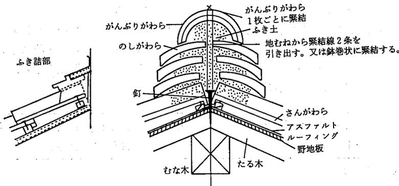
**留めつけ** 建築基準法施行令第39条に定める基準（建設省告示第109号昭46. 1.29）で「屋根がわらは、軒及びけらばから2枚通りまでを1枚ごとに、その他の部分のうちむねにあっては1枚おきごとに銅線、鉄線、くぎ等で下地に緊結し又はこれと同等以上の効力を有する方法ではがれ落ちないようにふくこと。」と規定されているが、本仕様で
