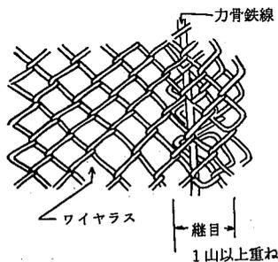
**メタルラス** 薄鋼板や亜鉛鉄板を材料として常温引伸切断法で製造する。JISには平ラス、波形ラス、リブラス、コブラスの四種類がある。ラスは、モルタルがラスの裏側にまで十分廻り込むことによって初めて補強硬化が出、ラスが腐食されにくくなる。したがって、ラスは防水紙との間に空げきができるような製品で、亜鉛めっきなどの防錆処理の厚手のラスを用いることが耐久性の向上からみて望ましい。
