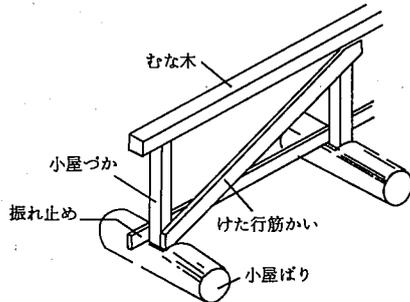
けた行筋かい、振れ止めの断面寸法は貫程度とする。
