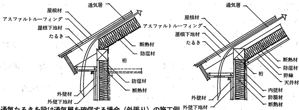
通気たるきを設け通気層を確保する場合（外張り）の施工例
