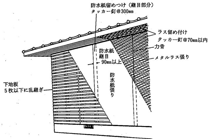
**ワイヤラス** 普通鉄線、なまし鉄線、亜鉛めっき鉄線をひし形、甲形又は丸形に編んだ網で、鉄線の直径は0.9mmから1.2mm、網目の寸法は20mmから38mmまでである。強度と耐久性などから鉄線の径が大きく網目の寸法の小さいものが良い。
