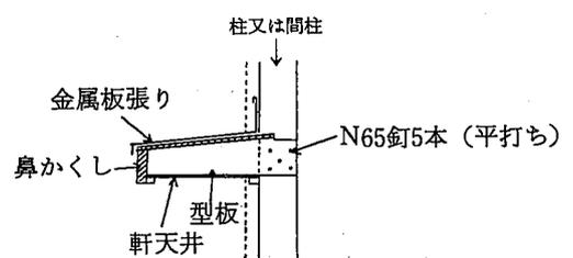
**腕木ひさし** 柱から腕木をのぼし、だしげたをのせ、その上に板をのせて金属板で葺いたものが一般的である。
