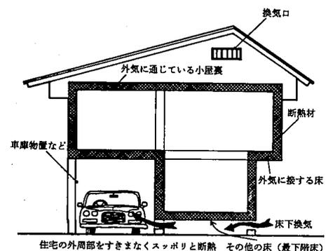
床下換気口が設けられた1階の床（その他の床）は、直接外気に接してはいないが床下を介して外気に接している。この場合の断熱材の厚みは、外気に接する床に比べ少し薄くてよいこととなっており、7.4(断熱性能)では「その他の床」として、はねだし床の場合のような「外気に接する床」と区別して数値が示されている。
