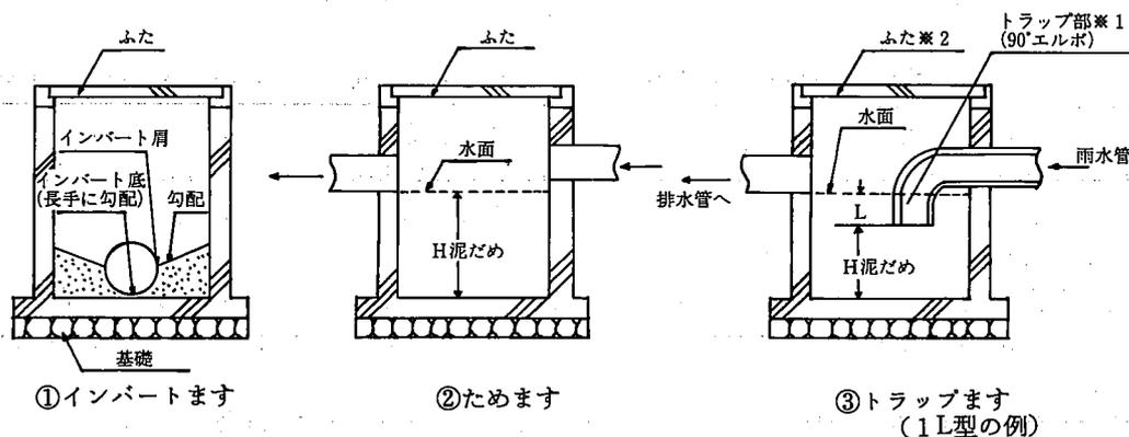
(注) 1. Lはトラップの封水深(50～100mm)を、Hは泥だめの深さ(150mm以上)をしめす。
