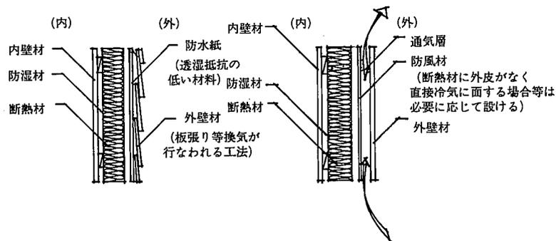
参考図 7.6.4 壁の断熱材施工例
