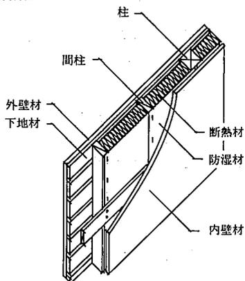
無機繊維系断熱材の充てん及びボード状断熱材の外張り併用 (真壁)
