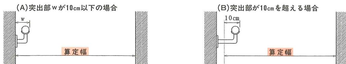
参考図4.5-1 階段の有効幅員の算定方法
