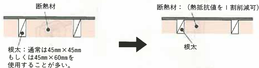
参考図1.3.4-3 床断熱の施工方法（Ⅲ地域での仕様例）
