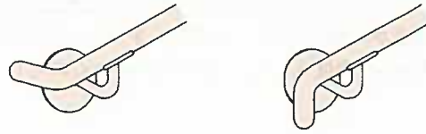
参考図3.5-3 手すり端部の曲げ処理
