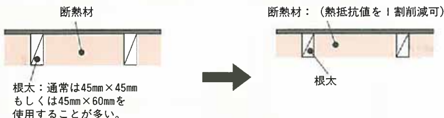
参考図1.3.4-3 床断熱の施工方法（Ⅲ地域での仕様例）
