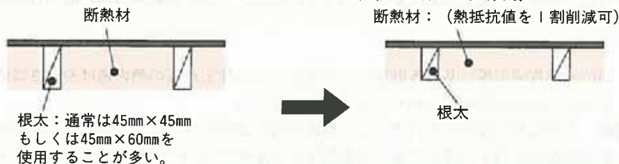
参考図7.3.4-3 床断熱のイメージ図（Ⅲ地域での仕様例）
