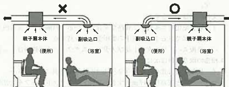
参考図16.4.2 親子扇を設置する場合の接続
