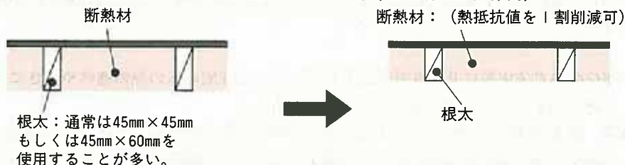
参考図7.3.4-3 床断熱のイメージ図（Ⅲ地域での仕様例）
