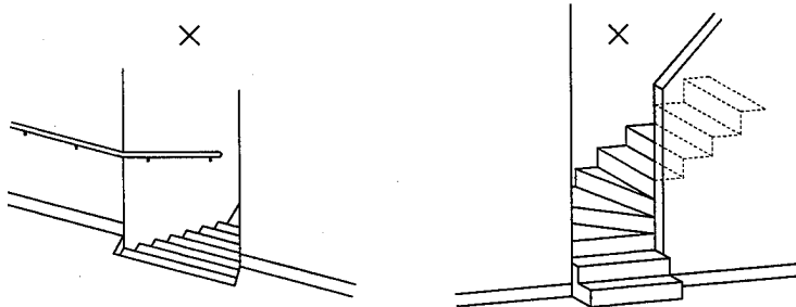
危険な階段の例
