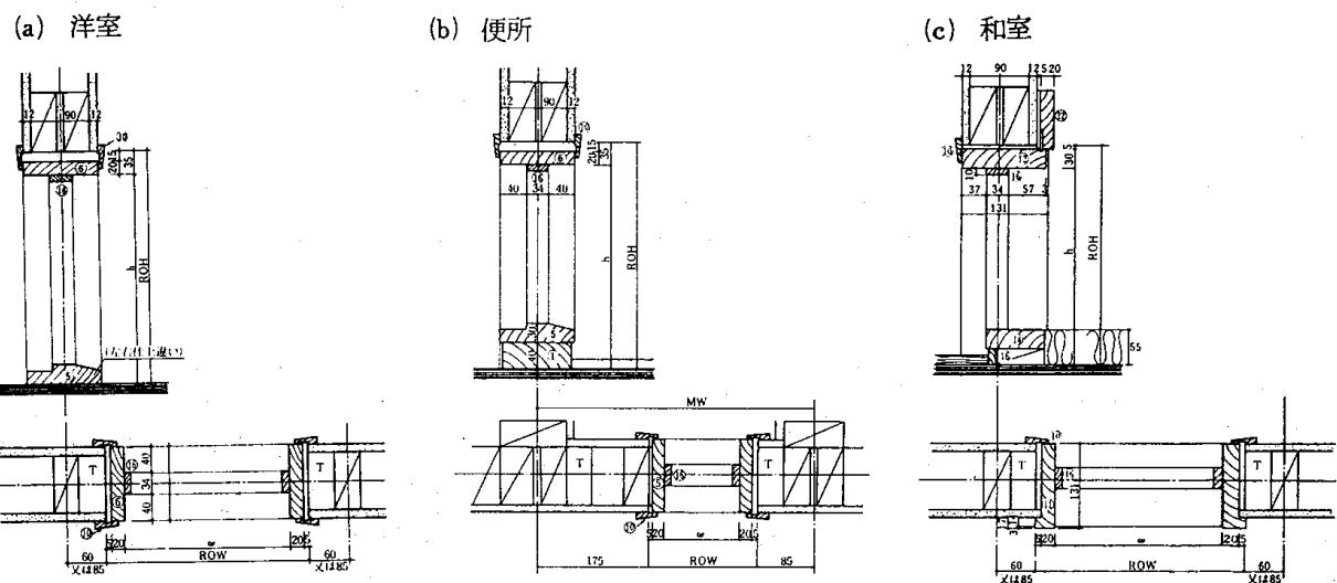
11.4-1 図 内部引違い戸の構成例を図示すると次のようになる
