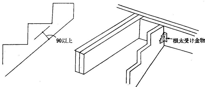
11.7-3図 ささら桁と踏み板との取り付け方
