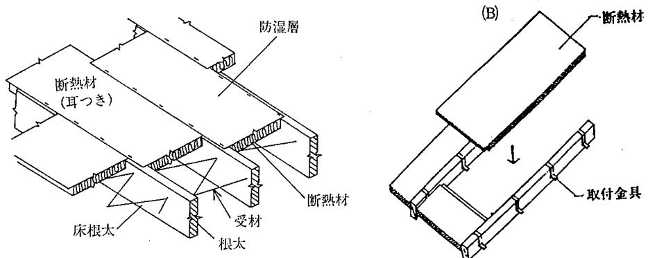
9.6-4 図 壁の断熱材の施工例
