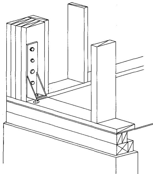
(A-1) 比較的引き抜き応力が大きい場合の施工例
