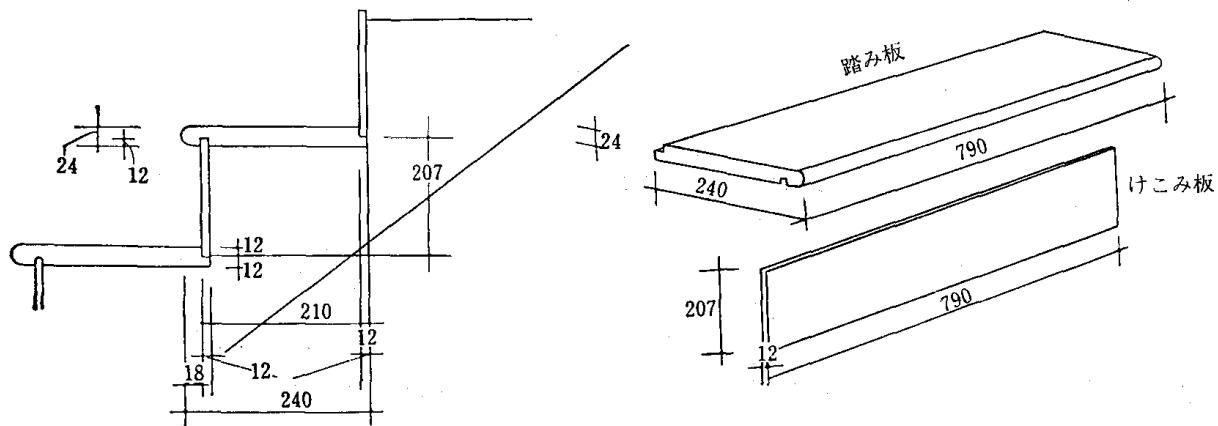
3図 曲がり階段の形状と寸法
