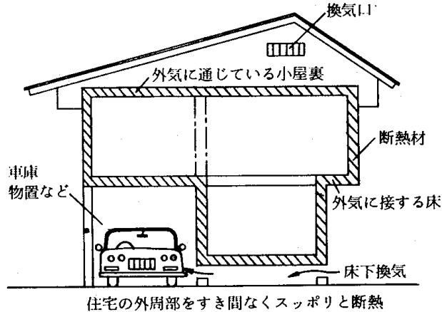
**断熱を必要としない部分** 9.3.2は断熱材を施工しなくてもよい部分のことです。i.は居住部分が断熱施工されなければそれに付属する物置等の断熱は必要ないということであり、ロ.は小屋裏換気が行われている場合の妻小壁などには断熱の必要はないということである。ハ.は直接居住部分に影響しない部分である。ニ.は玄関や勝手口の出入口の建具については、これらの部分が居室と建具や間仕切等で区画されれば断熱する必要はない。
