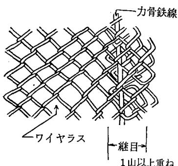
**メタルラス** 薄鋼板や溶融亜鉛めっき鋼板を材料として常温引伸切断法で製造する。現在はJISによる平ラス、波形ラス、リブラス、コブラスの四種類がある。ラスはモルタルラスの裏側にまで十分廻り込みラスを包み込むことによって、初めて補強効果が出、ラスが腐食されにくくなる。したがってラスは防水紙との間に空げきができるような製造のもので亜鉛めっきなどの防錆処理を施した厚手のラスを用いることが耐久性の向上からみて望ましい。
