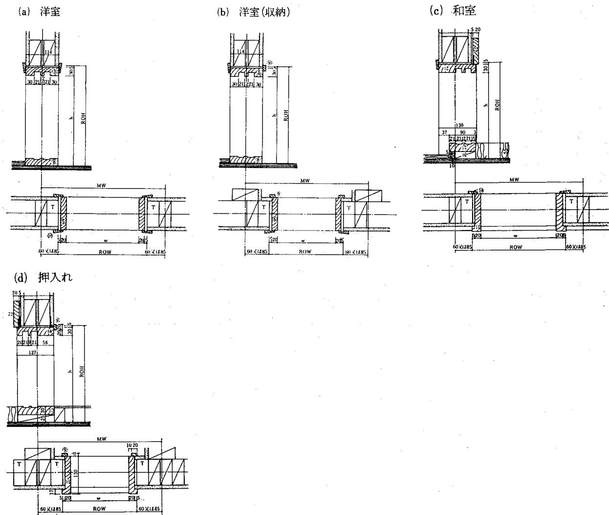
11.5—1図 アルミサッシの構成例を図示すると次のようになる
