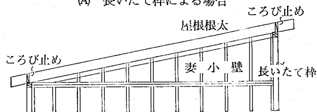
58図 片流れ屋根の構成
