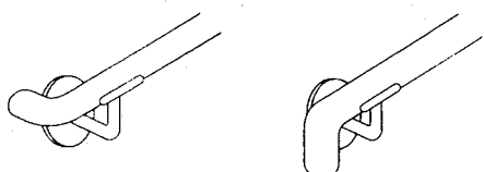
参考図 I. 4.4-2 手すり端部の曲げ処理
