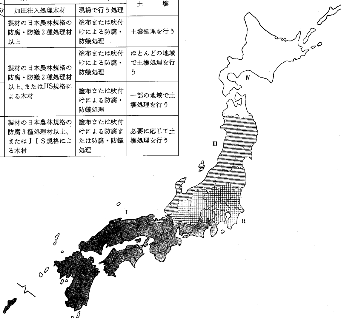
4.4 -1 図 建設地別の防腐・防蟻処理並びに防腐処理及び土壌処理の適用区分
