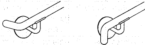
参考図3.5-3 手すり端部の曲げ処理
